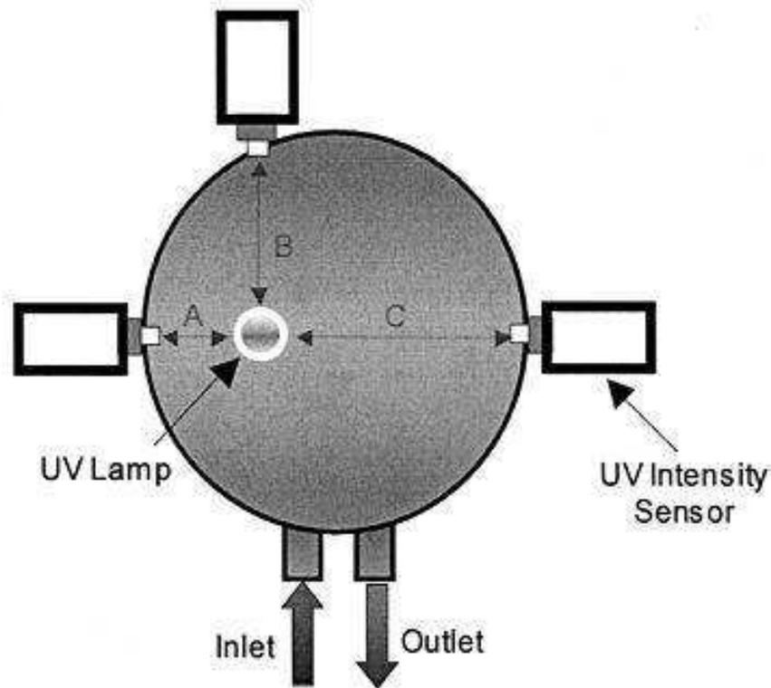
Figure 2.9 -- UVT Monitor Drawing<sup>9</sup>
