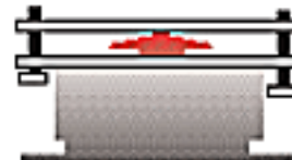
Long Bolt Manhole
